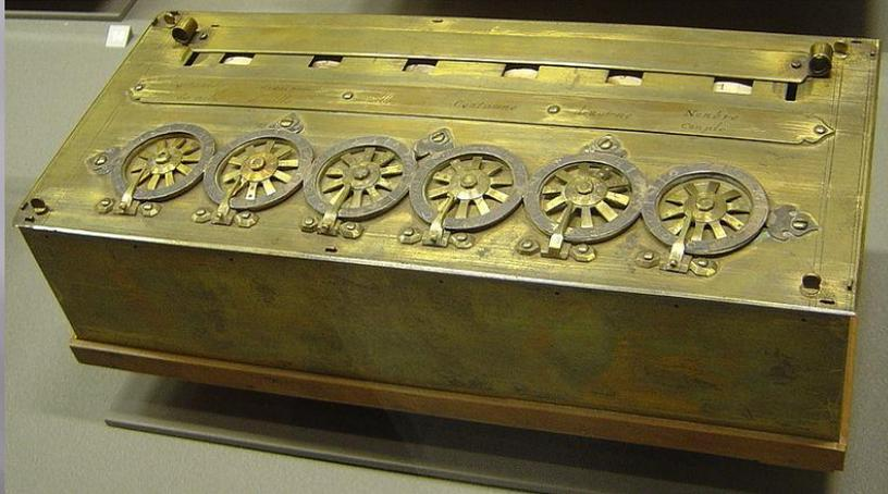
Première machine à calculer à six chiffres, elle permettait de faire des additions, des soustractions et des multiplications et divisions par répétitions.
