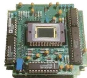
Dans l'appareil photo, le **capteur** est une cellule qui décompose l'image réelle en points lumineux (pixels) dont les caractéristiques (couleur, saturation et luminosité) sont codées numériquement.
