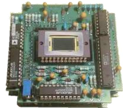
*Dans l'appareil photo, le capteur est une cellule qui décompose l'image réelle en points lumineux (pixels) dont les caractéristiques (couleur, saturation et luminosité) sont codées numériquement.*
